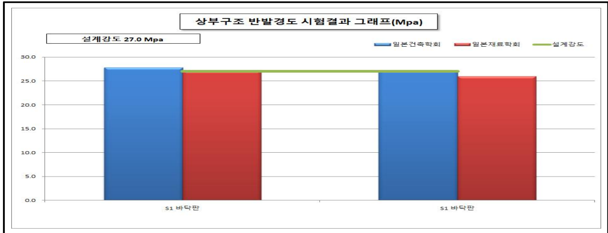
【그림 28.4.2】 상부구조 반발경도시험 측정결과
